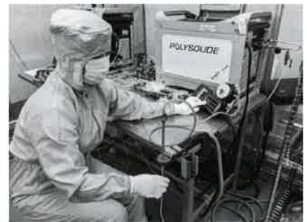
自動パイプ溶接機でチューブをつなぐ
